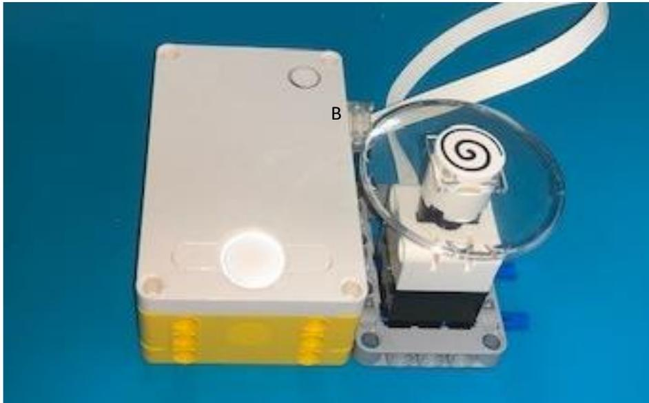
Para realizar un dado vamos a utilizar solo un sensor de color que hemos conectado en el puerto "B".
